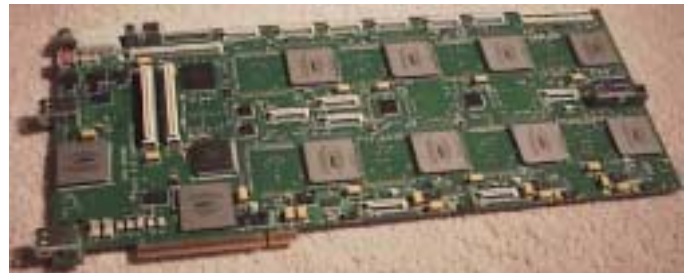
Figure 7. Scheda IBM PC, 3D-Flow™ DAQ per la rilevazione dei fotoni.
