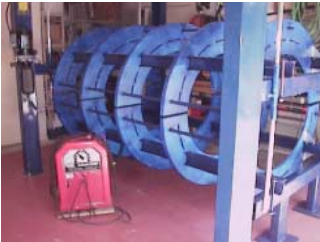
Figura 4. Struttura meccanica del 3D-CBS ospitante rilevatori di ogni tipo disposti in circolo intorno al paziente da formare una struttura di forma e lunghezza variabile (FOV da 16 a 180 cm di lunghezza). Esso consente la costruzione di un rilevatore circolare per il capo ed il tronco del corpo o con una qualunque forma ellittica per lo screening di una qualunque parte del corpo. La possibilità di sollevare la parte superiore dell'apparecchiatura risolve i problemi delle persone claustrofobiche quando il FOV deve essere aumentato.
